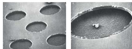
Ces deux photographies au microscope électronique montrent le relief micrométrique des perforations.
