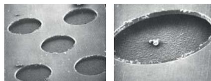
Ces deux photographies au microscope électronique montrent le relief micrométrique des perforations.
